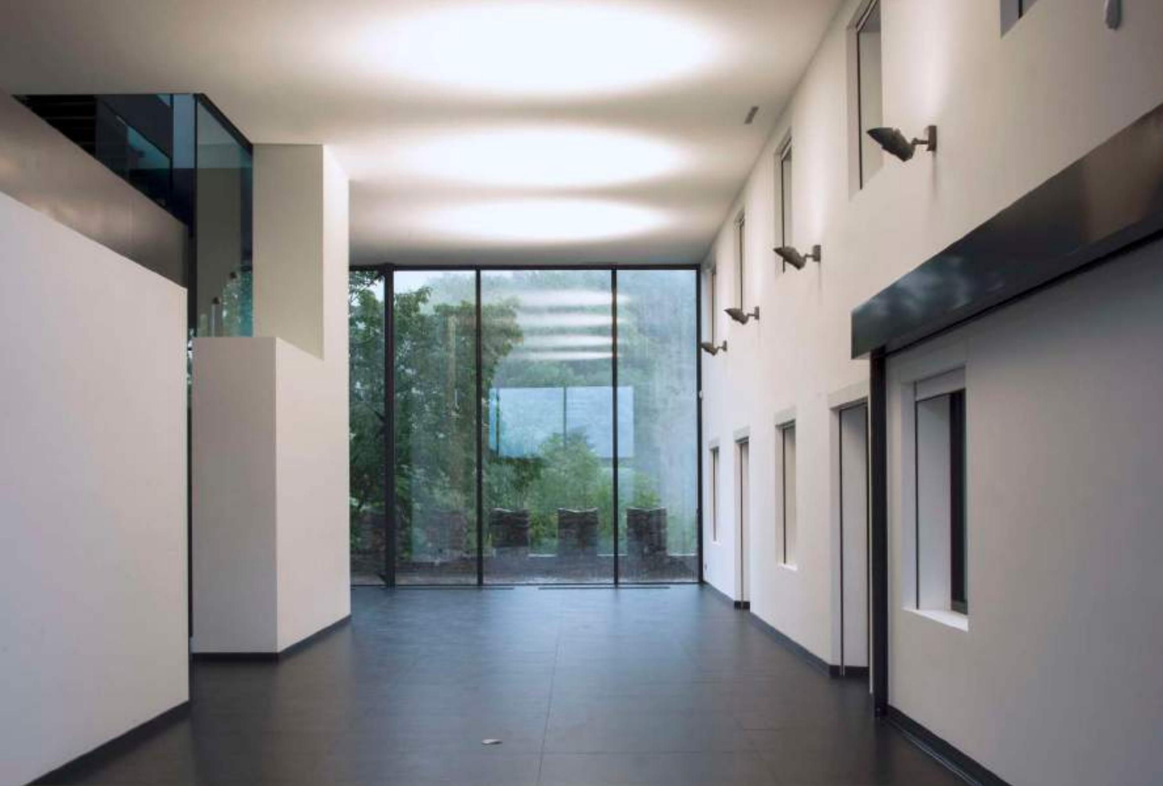
Per restituire l'antico prestigio al complesso e dare più respiro e generosità di luce al piano d'ingresso, mortificato dal precedente progetto, oltre alla demolizione di alcuni tavolati interni, è stata eliminata la soletta intermedia tra il piano terra e il primo piano creando un ampio vano a doppia altezza più confacente all'antica vocazione dell'edificio.
